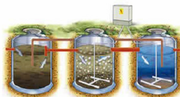
Eksempel rensanlegg for 100 pe
